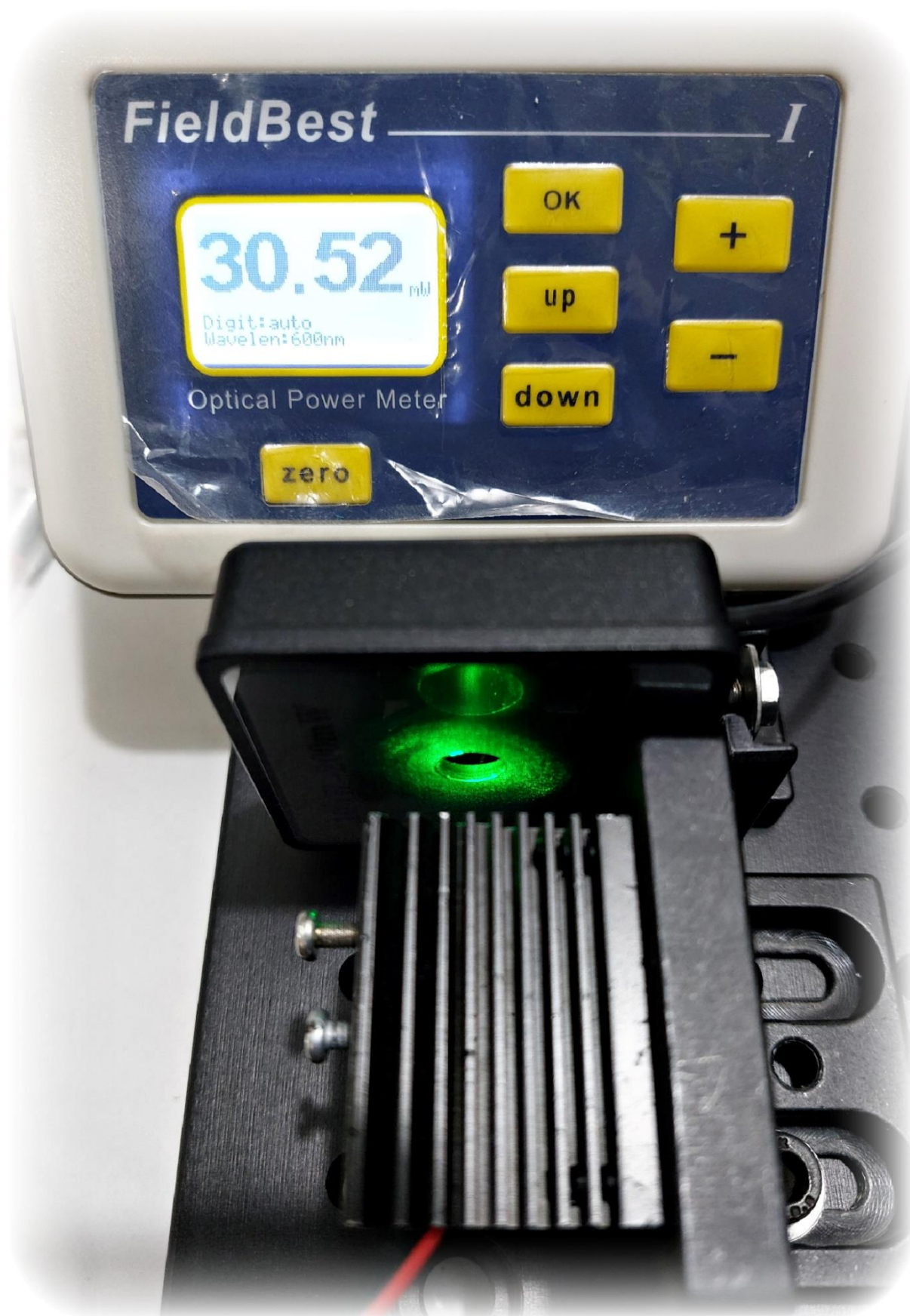
شکل ۳: بیشینه توان ماژول لیزر ۵۲۰ نانومتر.
