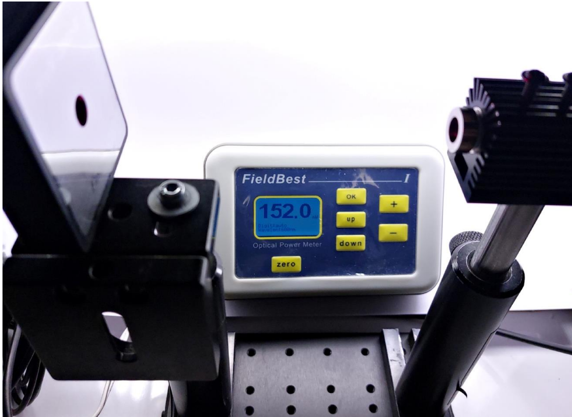
شکل ۴: توان‌سنجی از ماژول لیزر ۶۶۴ نانومتر ۱۵۰ میلی‌وات.
