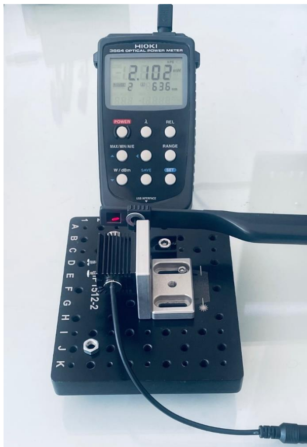
شکل ۳: توان ماژول لیزر ۶۳۸ نانومتر
