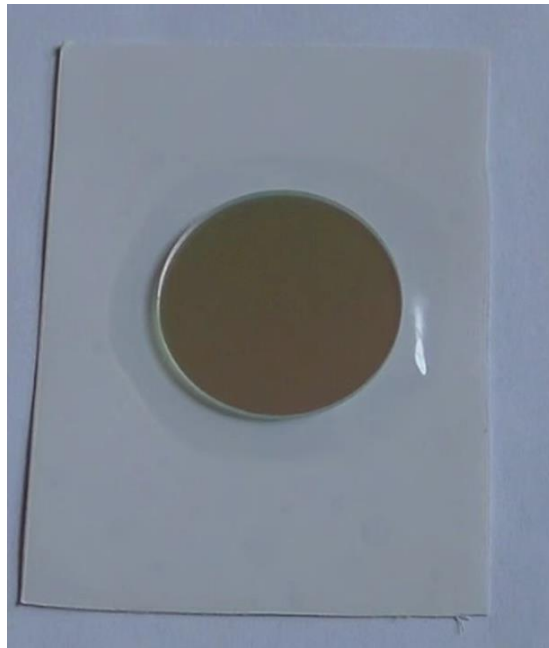
شکل ۲: نمای ظاهری فیلتر بندپس ۴۱۰ نانومتر دایره‌ای.
