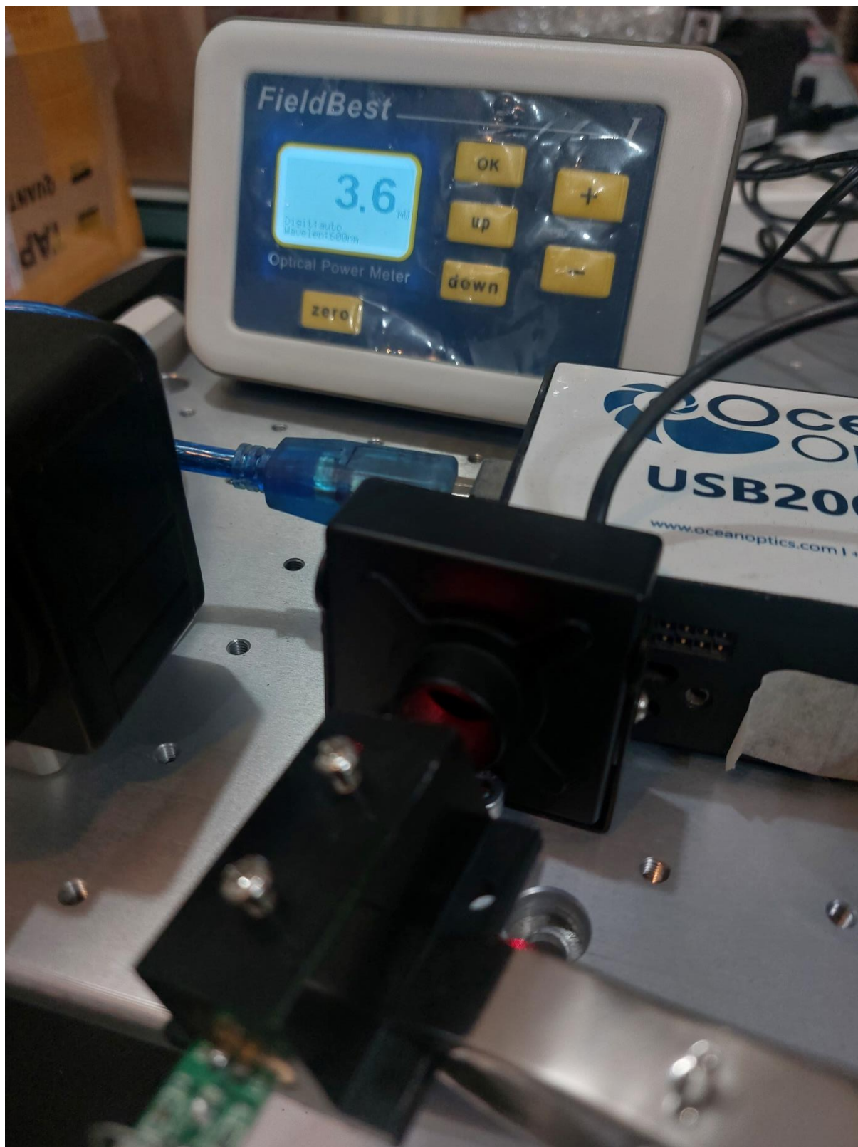
شکل ۳: توان نمونه ماژول لیزر ۶۳۵ نانومتر.
