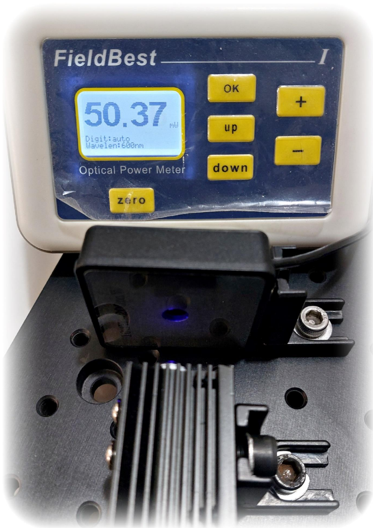
شکل ۳: پیشینه توان ماژول لیزر ۴۰۵ نانومتر.
