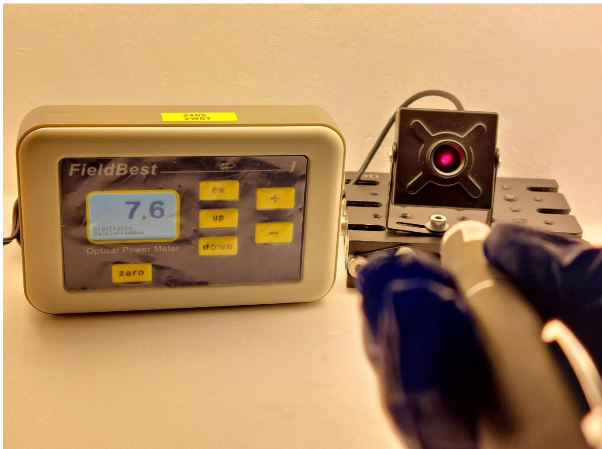
شکل ۲: طیف و بیشینه توان لیزر پوینتر ۶۵۰ نانومتر
